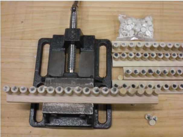
8/12 レギュレーティングボタンブッシング剥がし
