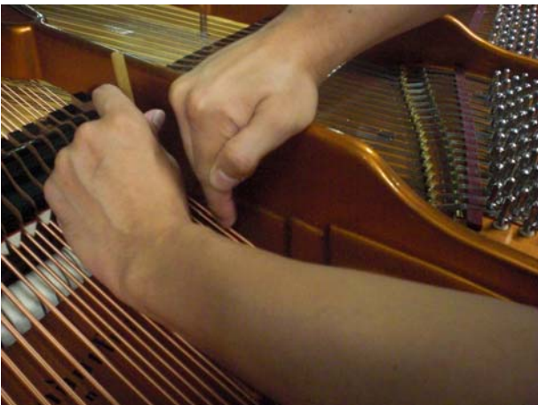
9/12 三弦合わせ ハンマーフェルトと弦がしっかり当たるように調整
