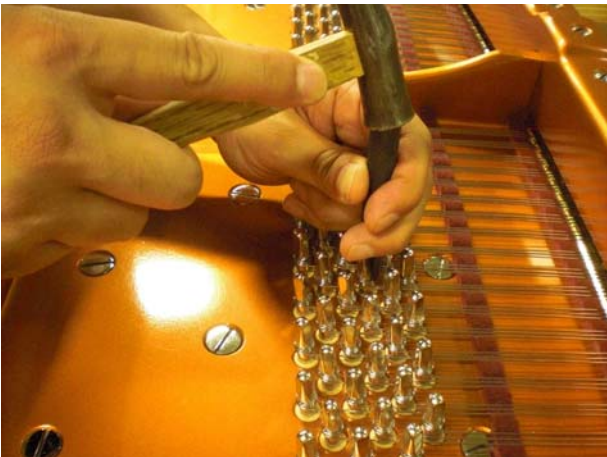
7/11 チューニングピン打ち下ろし
