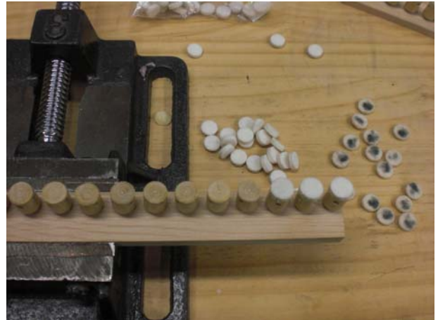
8/12 レギュレーティングボタンブッシング交換
