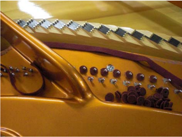
6/24 弦枕・ヒッチピンクロス交換
