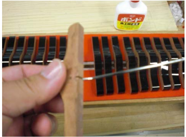
7/7 ダンパーライニングフェルト貼り
