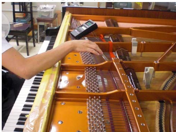
7/19 ピッチ上げ ダンパー取り付け後何度も音の高さを上げる
