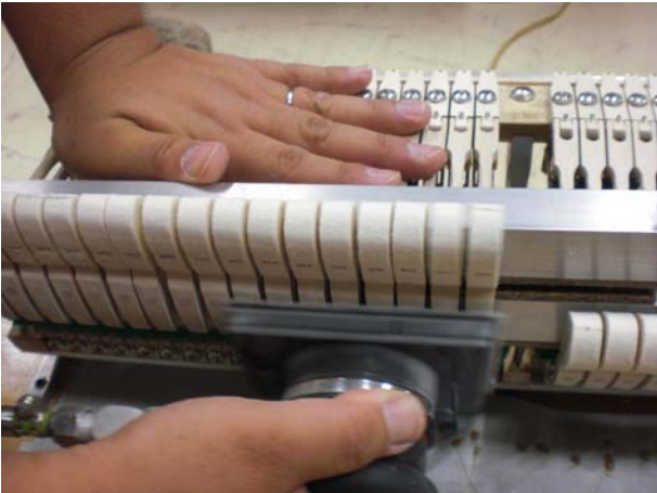
8/26 ハンマーテール全体加工
