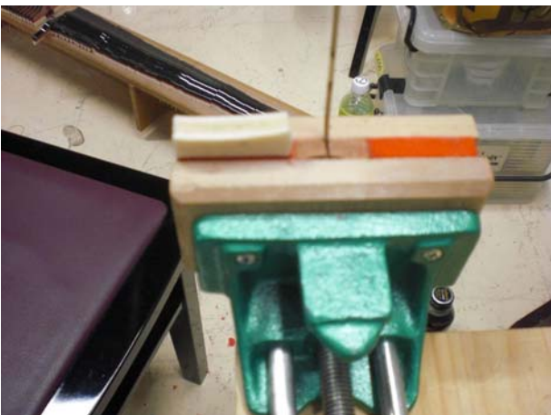
7/6 ダンパーフェルト剥がし
