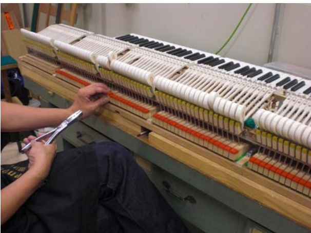
9/2 調整 整音前の細かい調整
