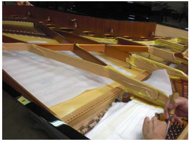
解体 フレームを傷付けない様に養生をして弦を外す
