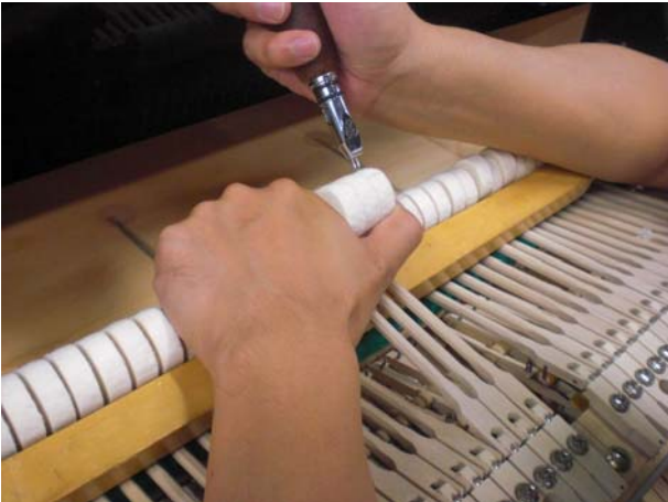
9/12 第一整音 ハンマーフェルトに針を入れて弾力をつける
