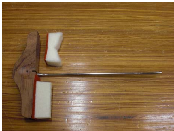
7/11 平ダンパーフェルト接着
