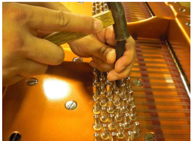
7/11 コイル打ち下ろし
